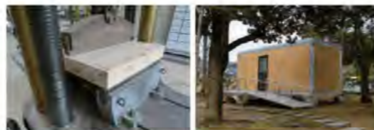
パネルのせん断試験 仮設住宅工法
