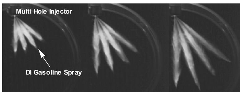
図3 直接噴射ガソリン噴霧
