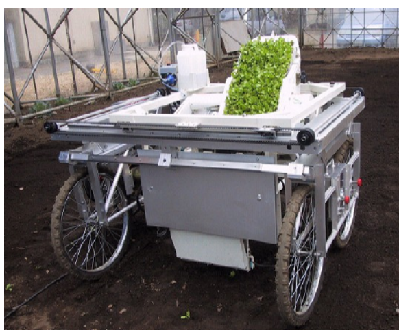
(b) 耕うん・定植用作業機を搭載した 作業ロボット
